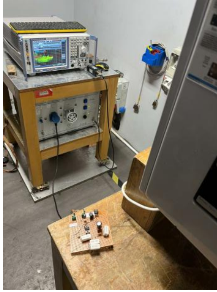
Şekil 5. Tasarlanan BOOST Devresi ve Gürültü Test Ölçüm Ortamı
