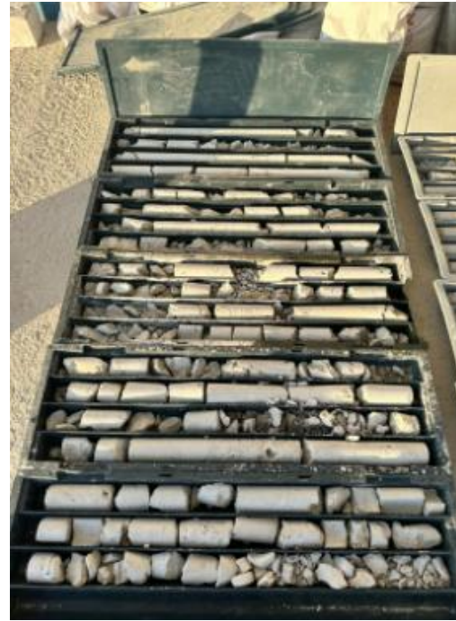
Şekil 6. DSM uygulaması sonrası oluşan kolonlardan alınan zemin numuneleri
