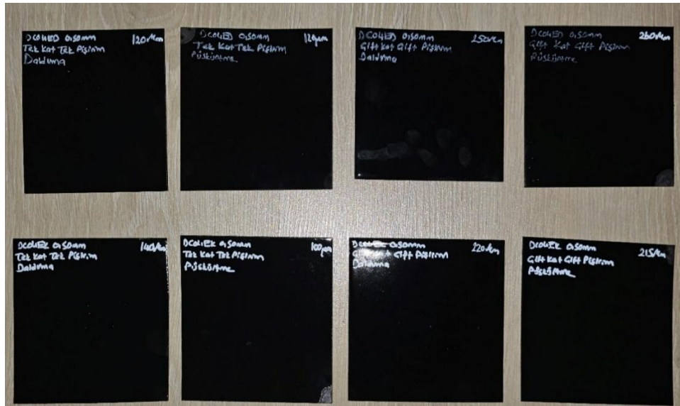
Şekil 2. 0,50mm ve 0,70mm DC04ED ve DC04EK Tek ve Çift Kat Daldırma ve Püskürtme Yöntemiyle Kaplanmış Emaye Kaplama Görselleri
