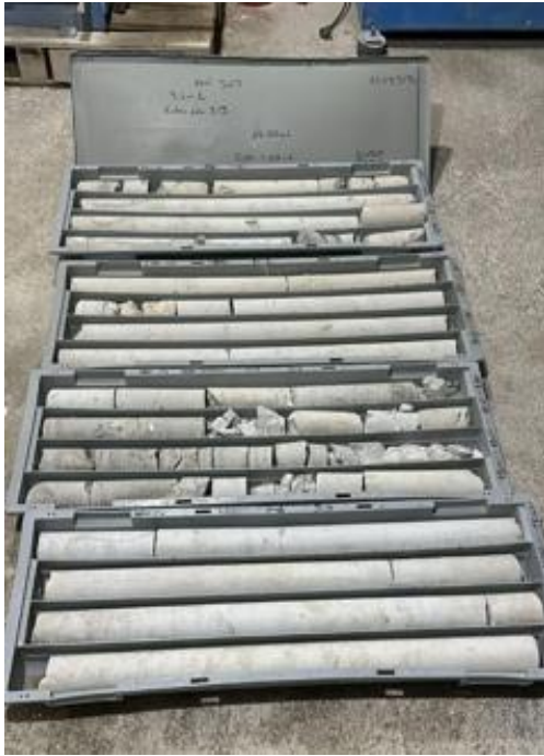
Şekil 6. DSM uygulaması sonrası oluşan kolonlardan alınan zemin numuneleri
