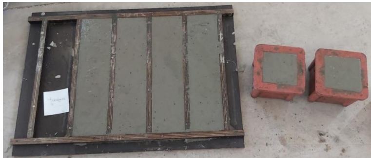
Şekil 2. Kiriş ve küp beton numuneleri
