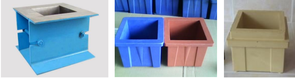
Şekil 1. Numune kalıp görünümleri (soldan sağa; çelik, yerli, ithal)
