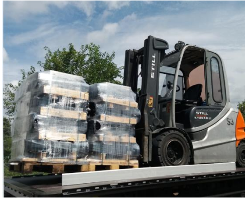
Şekil 13. Taban testi ve yüklü forklift
