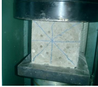
Şekil 7. Schmidt Okuması İçin Numune İşaretlemeleri
