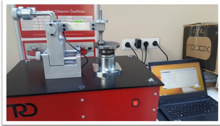
Şekil 2. Pin-on disk aşınma cihazı
