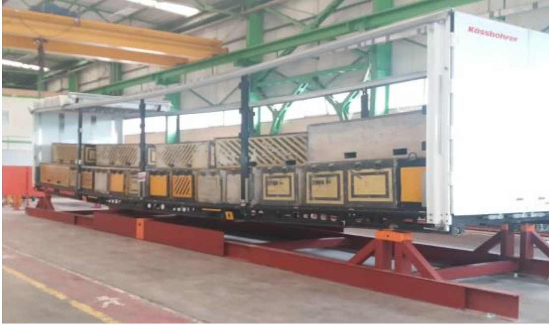
Şekil 6. M1.1 ITU(Swapbody) yapının üzerine 63.000 kg yüklü görüntüsü
