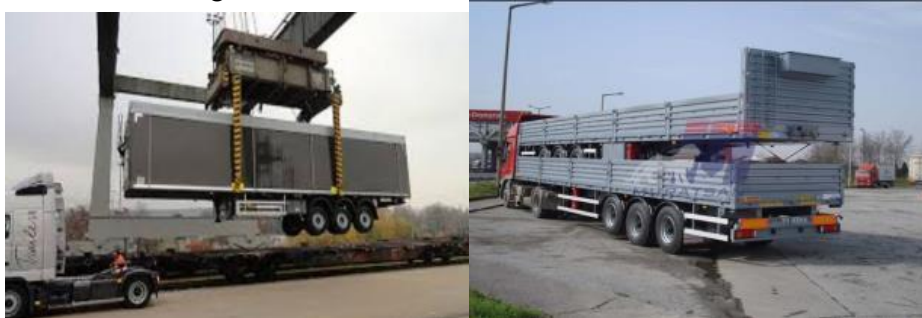
Şekil 2. Vinç Yardımıyla Tren Vagonu Üzerine Yüklemiş ve Üst Üste Yüklemiş Römork Görselleri
