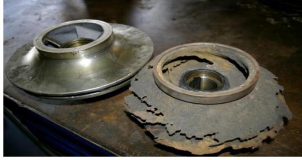
Şekil 4. Kostik pompa fanında uzun süre çalışma sonrasında oluşan erozyon
