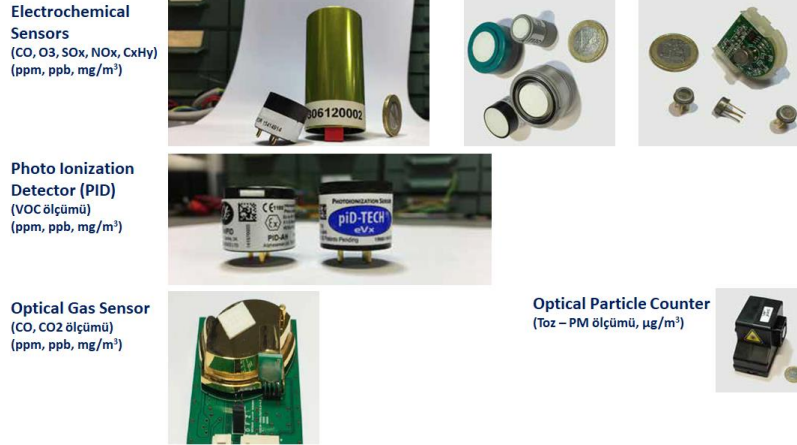
Şekil 2. Hava Kalitesi Ölçümlerinde Kullanılan Sensör Tipleri (Gerboles ve diğ., 2017).
