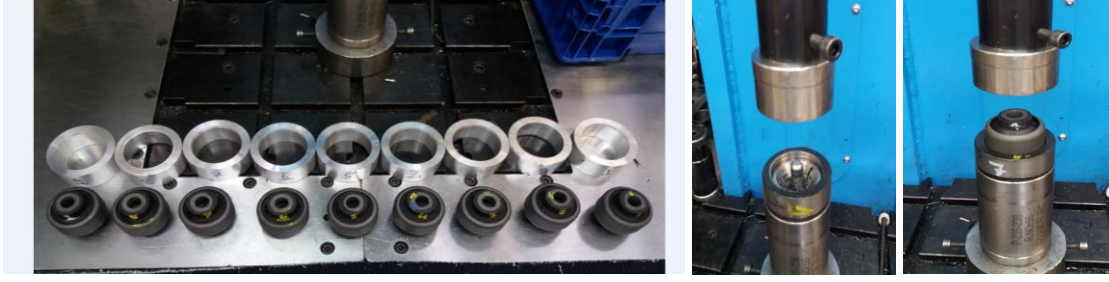
Şekil 5. Burçlara yapılan numaralandırma çalışması ve burcun çakılması
