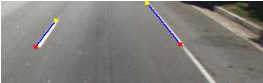
Şekil 4. Hough çizgilerinin elenmesi a) Hough çizgileri b) Puanlama sonrası tespit edilen şerit çizgileri
