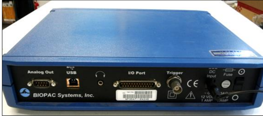
Şekil 1. EOG ölçümlerinde kullanılan biopack cihazı
