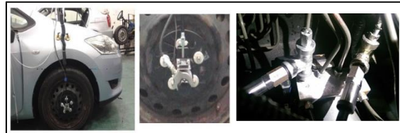
Şekil 1. Enkoderin taşıta bağlanması ve basınçölçer
