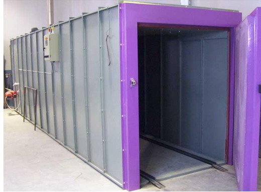
Şekil 11 Test için kullanılan boya fırını.
