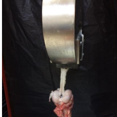
Şekil 1. Üniversal test cihazı çenesine bağlanmış büyük baş hayvansal tendon.
