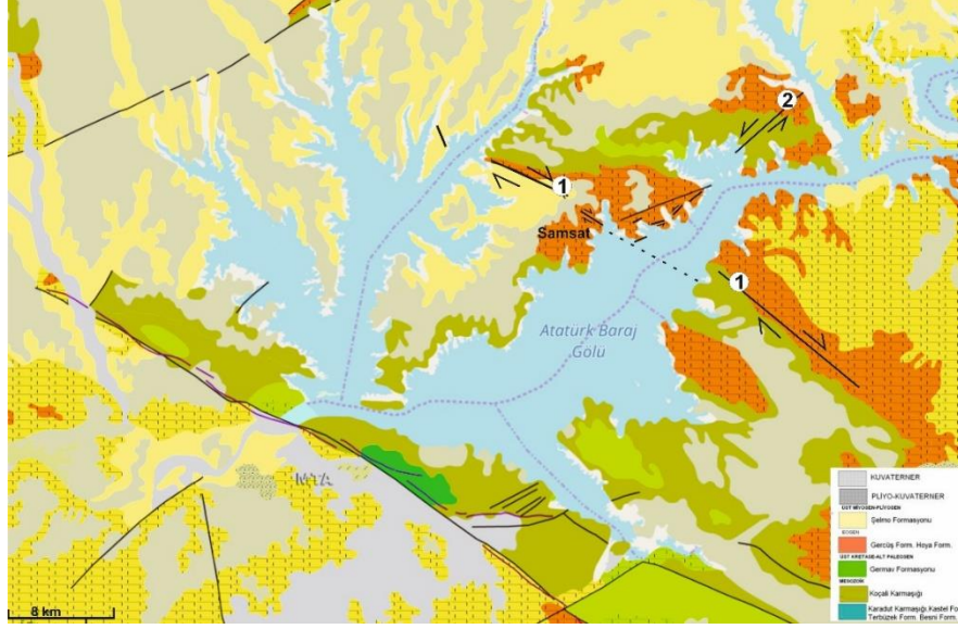
Şekil 2. Samsat (Adıyaman) ve civarındaki jeolojik birimler ve bu çalışma ile haritalanan ve türleri belirlenen 1 ve 2 no'lu doğrultu atımlı faylar (Karadoğan ve Tonbul, 2013; MTA,2018).
