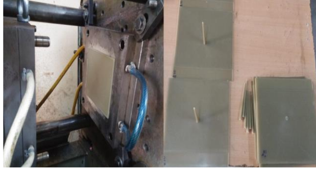
Şekil 6. Enjeksiyon ile üretilen kompozit levhalar
