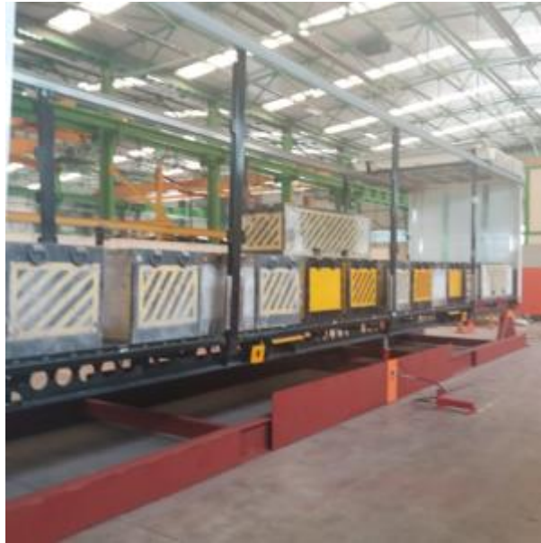
Şekil 9. M 1.2 ITU(Swapbody) yapının üzerine 46.000 kg yüklü görüntüsü
