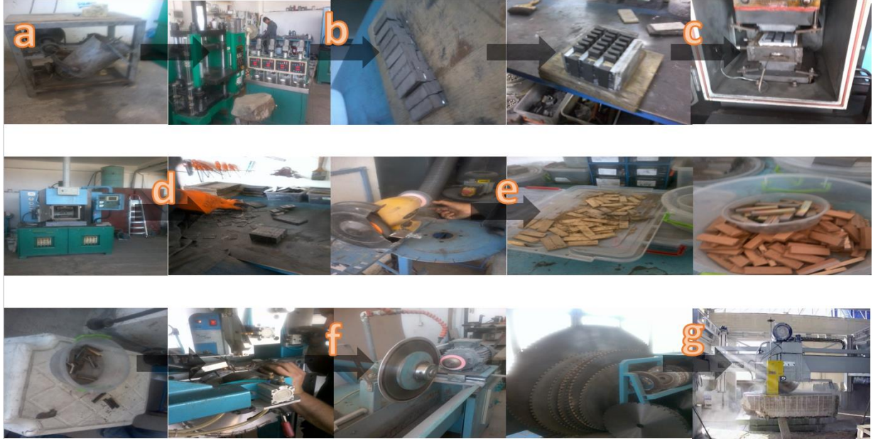
Şekil 3. (a) Bronz esaslı Co-Ni-Sn tozlarının karıştırılması, (b) Karıştırılan tozların soğuk preslenmesi, (c) Grafit kalıba soğuk preslenen numunelerin dizilmesi, (d) Sıcak izostatik presleme ile numunelerin kimyasal olarak biraraya gelmesi, (e) Doğal taş kesici takımların çapaklarının alınması ve yüzeylerinin temizlenmesi, (f) Lehimleme tekniği ile doğal taş kesici takımların testere üzerine kaynatılması ve (g) Doğal taş kesici testere boyutlandırılması, eğimliliğinin test edilmesi ve fabrika ortamında doğal taş kesim uygulamasına alınması
